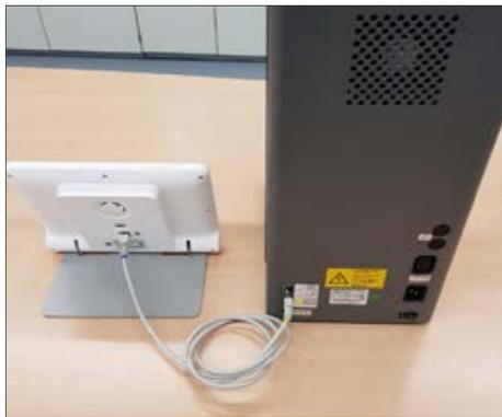
Das vPad wird direkt am Brenngerät angeschlossen
